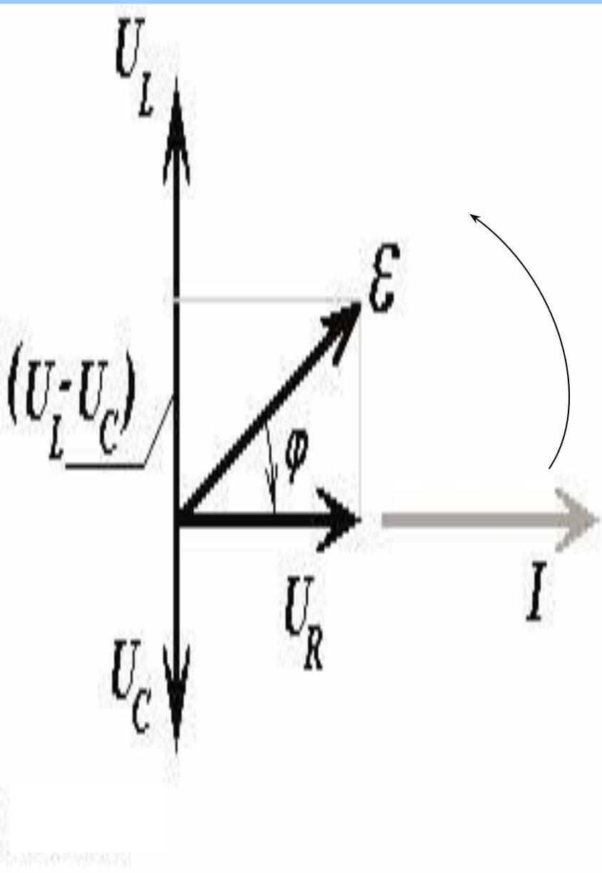
1. Задают ось тока – вектор, показывающий колебание силы тока в цепи с частотой  $\omega$  (вращение его по окружности).
