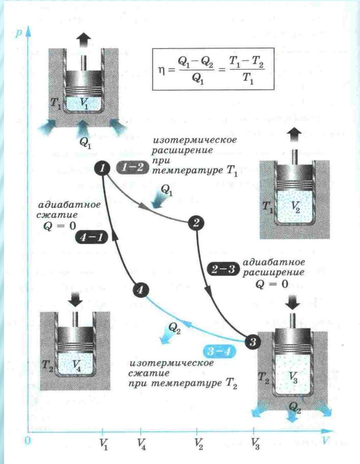
□ 1 – 2 - изотермическое расширение.
