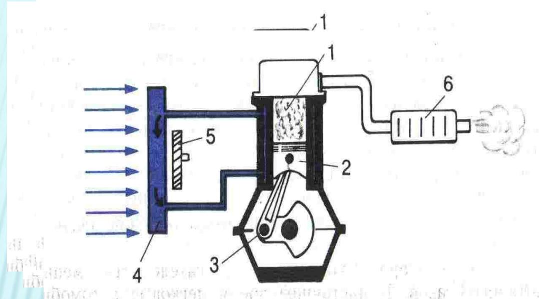
Схема двигателя внутреннего сгорания.
