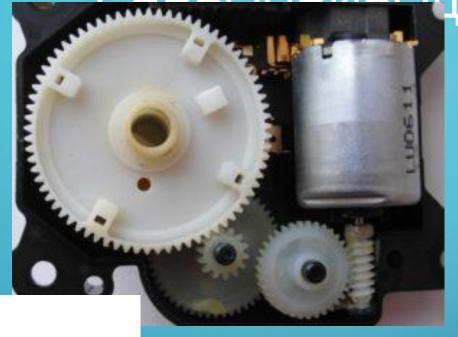
У большинства сервоприводов связующим звеном между валом и внешними элементами является шестеренка, поэтому очень важно, из какого материала она сделана. Наиболее доступных вариантов два: металлические или пластмассовые шестерни. В более дорогих моделях можно найти элементы из карбона и даже титан
