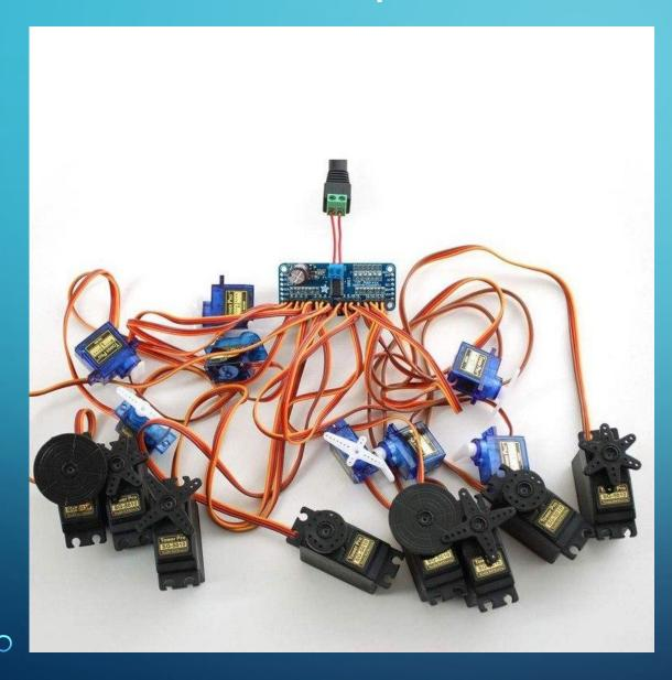
• Широкое использование сервоприводов связано с тем, что они обладают стабильной работой, высокой устойчивостью к помехам, малыми габаритами и широким диапазоном контроля скорости. Важными особенностями сервоприводов являются способность увеличивать мощность и обеспечение обратной информационной связи. И этого следует, что при прямом направлении контур является передатчиком энергии, а при обратном – передатчиком информации, которая используется для улучшения
