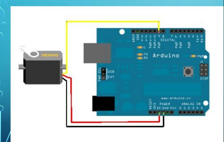
• Сервопривод обладает тремя контактами, которые окрашены в разные цвета. Коричневый провод ведет к земле, красный к питанию +5В, провод оранжевого или желтого цвета сигнальный. К Ардуино устройство подключается через макетную указанным на рисунке образом. Оранжевый провод (сигнальный) подключается к цифровому пину, черный и красный – к земле и питанию
