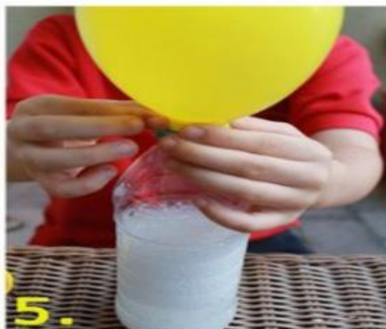
5. При добавлении соды в уксус выделяется углекислый газ
