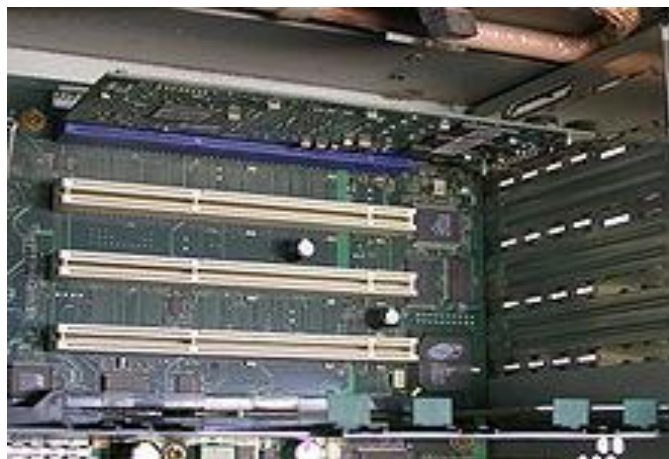
Разъёмы PCI-X на материнской плате сервера FSC Primergy TX200 S2. Синий разъём заполнен специально предназначенной платой нуль-канального RAID (zero-channel RAID, ZCR)
