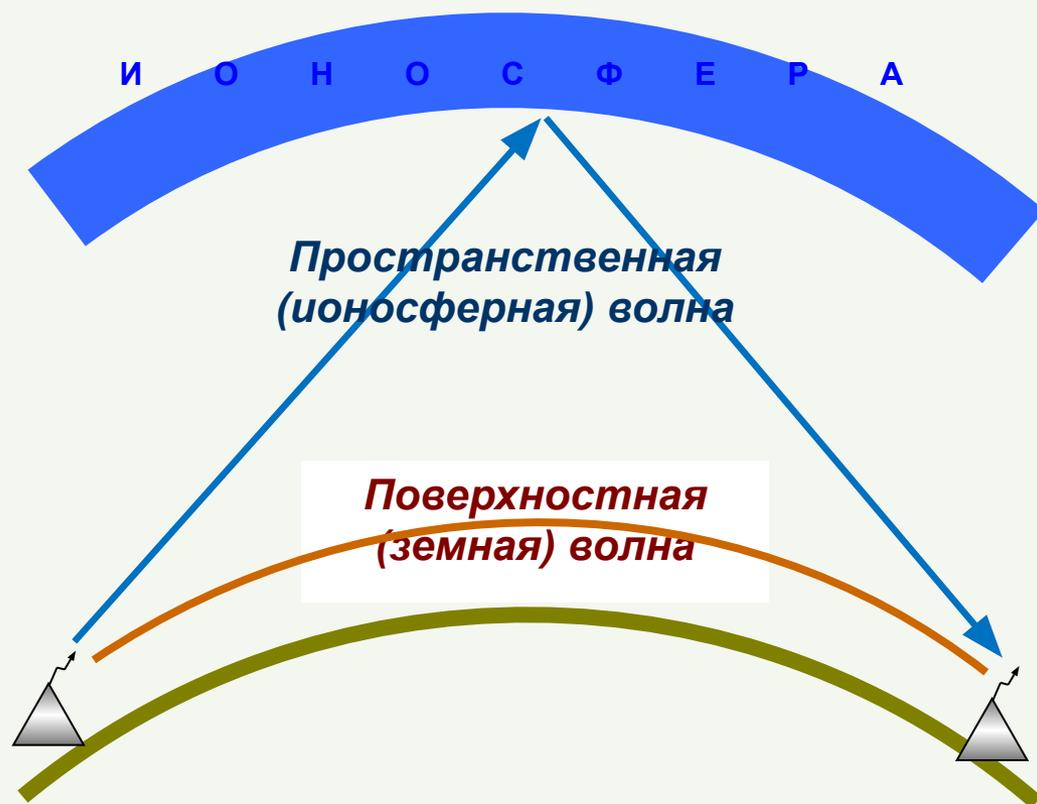
Скорость РРВ в ионосфере уменьшается по мере проникновения их из электрически менее плотной области в электрически более плотную. Это приводит к изменению направления РРВ и ее возвращению на поверхность земли.
