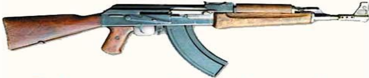
Первый опытный автомат Калашникова 1947 года, также известный как АК-47
