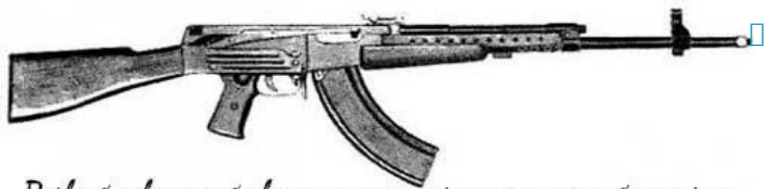
Первый советский автомат под промежуточный патрон образца 1943 года (7.62x41) - автомат Судаева АС-44, прошедший войсковые испытания весной-летом 1945 года.
