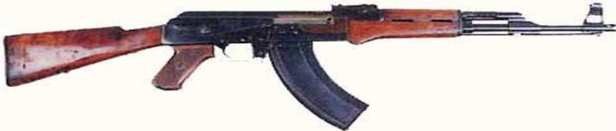
Опытный автомат Калашникова 1947 года, вторая модель
