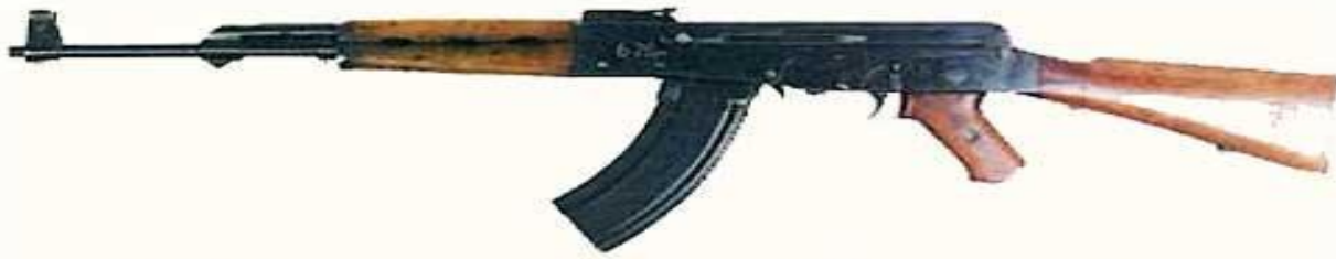
Первый опытный автомат Калашникова под патрон 7.62x41, 1946 год, также известный как АК-46
