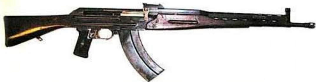
Опытный автомат Бурдкова АБ-46, оказавший значительное влияние на конструкцию автомата Калашникова АК-47
