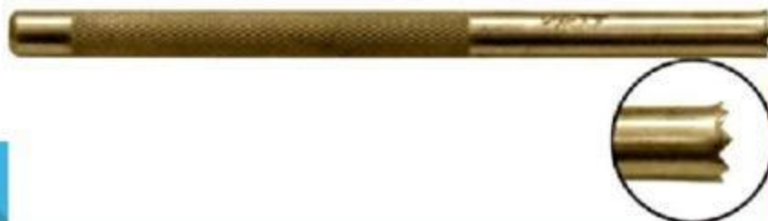
Рис. 75. Инструменты для пробивания отверстий в кирпичной или бетонной стене: а — пробойник; б — шлямбур
