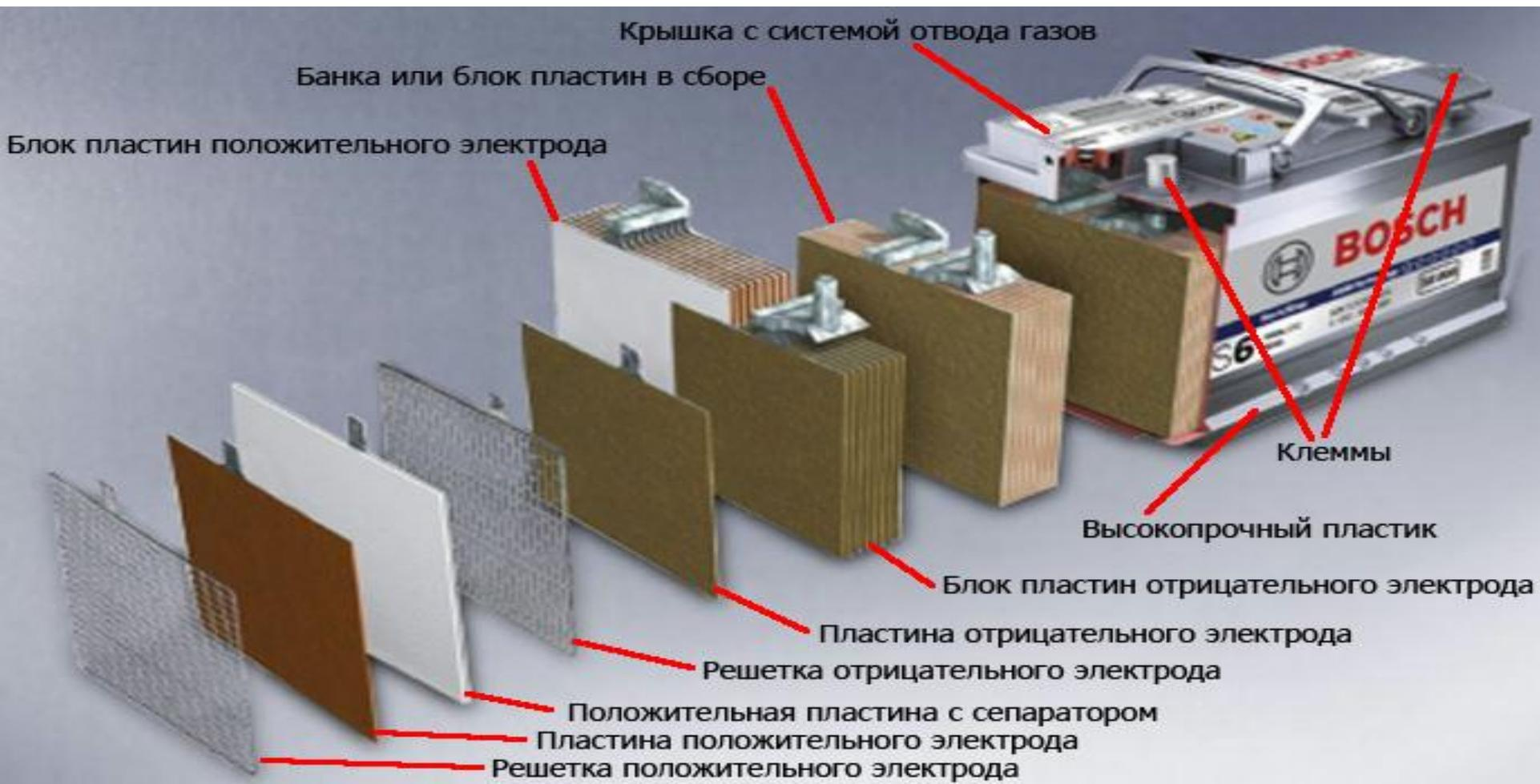
Конструкция свинцовых электродов гелевых АКБ может быть плоской и спиральной
