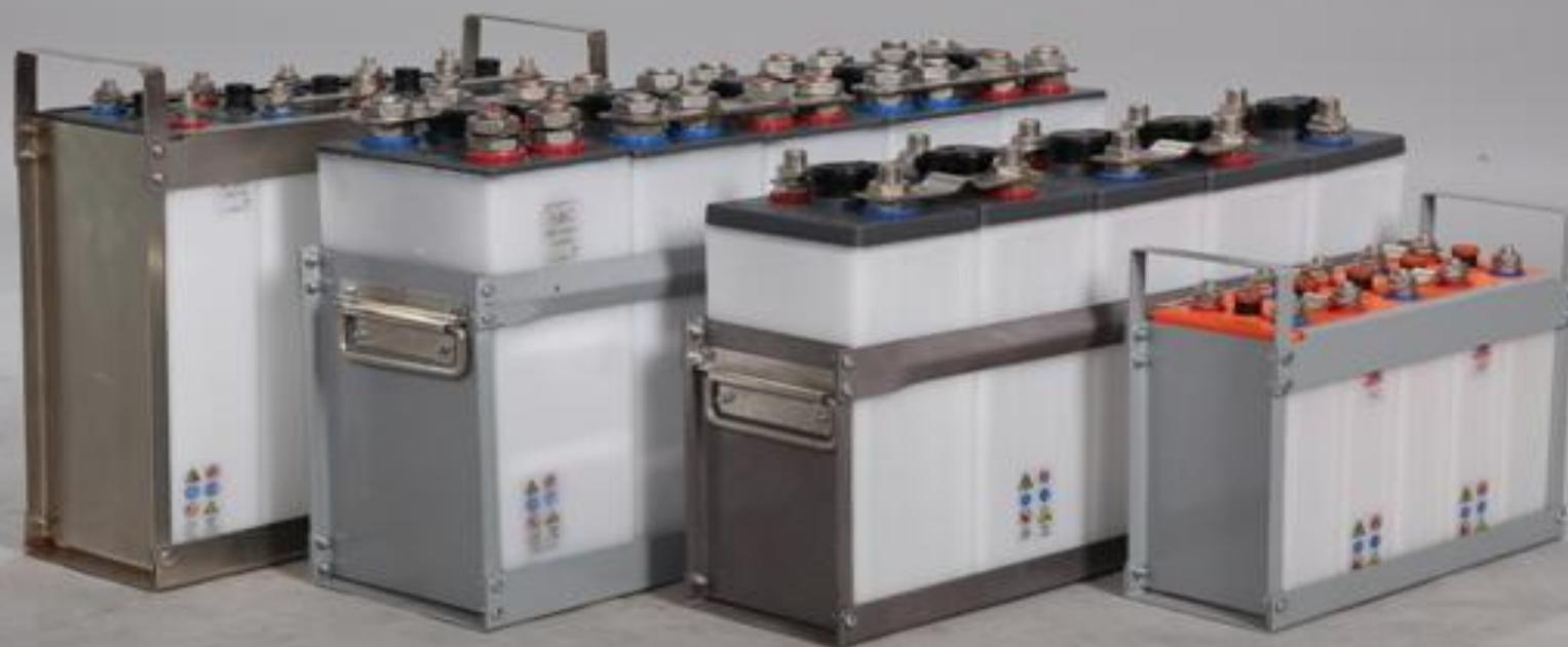
У обоих типов аккумуляторов в заряженном состоянии активная масса положительного электрода состоит из  $\text{NiOOH}$  (гидроокись никеля) с добавлением окиси бария и графита. Графит предназначен для увеличения электропроводности активной массы. Добавка окиси бария увеличивает срок эксплуатации щелочного аккумулятора
