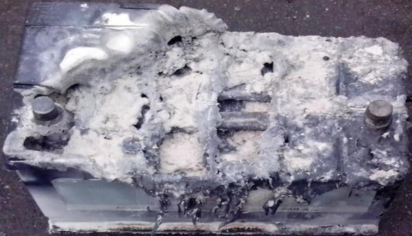
После нескольких глубоких разрядов автомобильных аккумуляторов кальциевого типа, их можно отправлять на свалку.
