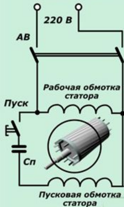
Схема подключения двигателя за счет конденсаторного сдвига фаз
