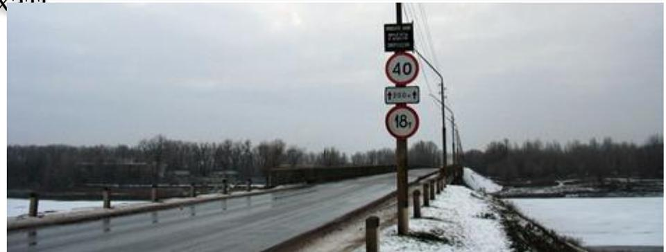
Знак «Ограничение массы» может применяться на мостовых, путепроводных и эстакадных сооружениях, где результатами специальных исследований ограничивается их грузоподъемность. Опорные конструкции данных строений не должны испытывать преобладающего давления, и указанный знак регламентирует максимально возможную нагрузку на них.
