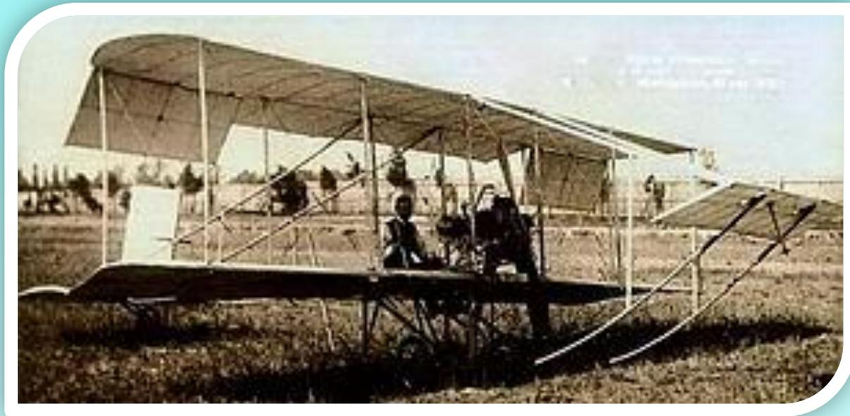
Биплан деревянной конструкции с вынесенными на фермах передним рулём высоты и хвостовым оперением. Длина самолёта 10 м, размах крыльев 9 м, их суммарная площадь 34 м<sup>2</sup>. Обтяжка крыльев — из прорезиненного полотна, двигатель «Анзани» мощностью 25,7 кВт. Полетная масса 420 кг. Полёт, выполненный Кудашевым 23 мая 1910 на Сырецком ипподроме в Киеве, стал первым в России полётом самолёта отечественной постройки.
