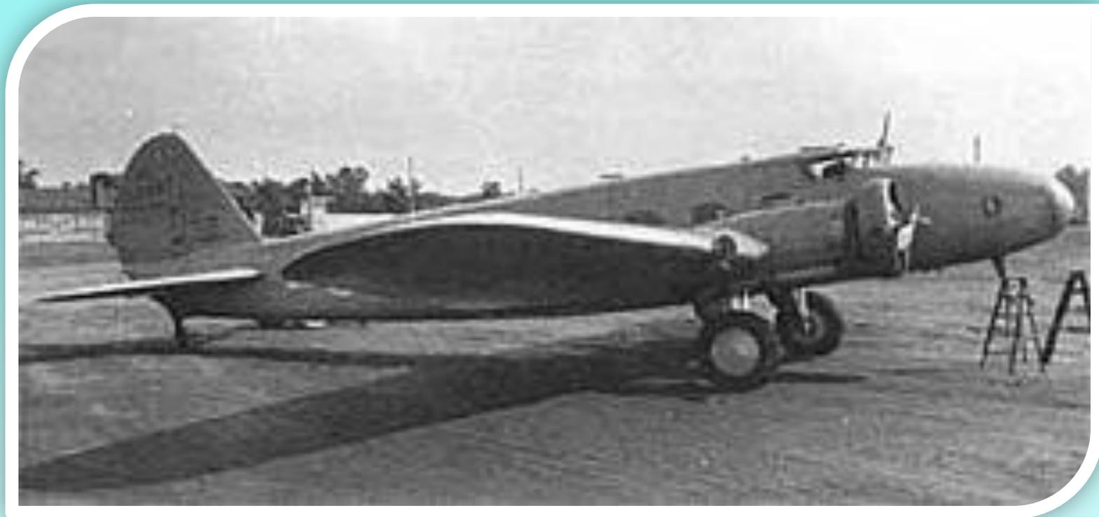
Американский 10-местный пассажирский самолёт, первый серийный цельнометаллический авиалайнер со свободнонесущим крылом, убирающимся шасси, фюзеляжем типа полумонокок и автопилотом. Первый полёт был проведён в 1931 году.
