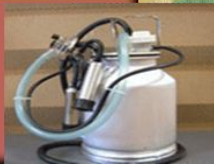
Аппарат УИД 07.000 для доения в переносные ведра
