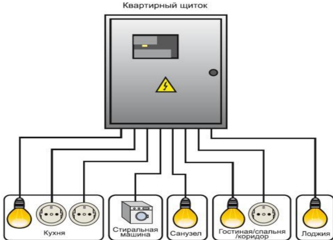
Однолинейная (принципиальная) схема служит для верной сборки электроцита и упрощения чтения плана с распределительными группами.
