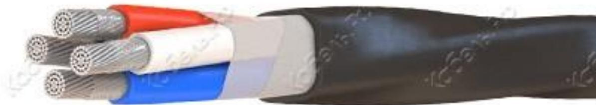
**АВРГ 5х2,5-380** – кабель с алюминиевыми жилами, резиновой изоляции, в ПВХ оболочке, без защитного покрова 5-жильный, с площадью сечения жилы 2,5 мм, на напряжение 380 В.
