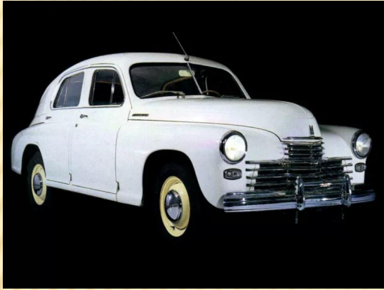
1946 ГАЗ-М-20 «Победа» с революционным кузовом полностью понтонного типа
