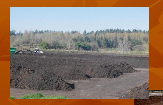
ТБО разгружают на выровненную площадку. Бульдозером, формируют штабеля, в которых происходят процессы аэробного биотермического компостирования.
