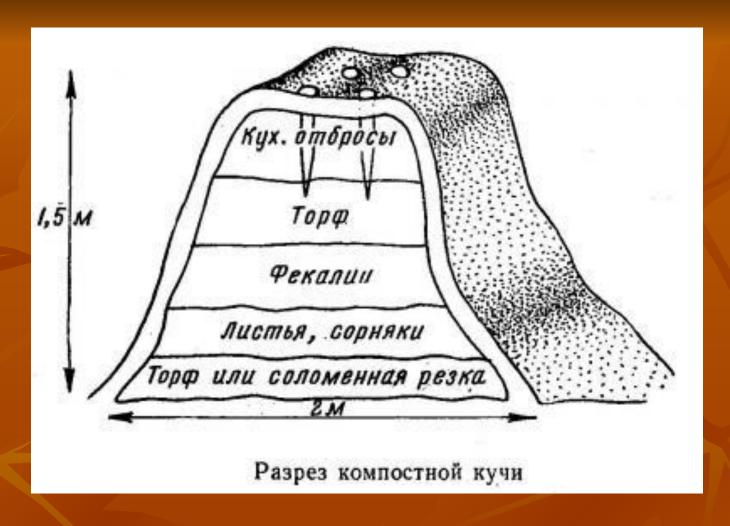
Для предотвращения развеивания бумаги, выплода мух, устранения запаха поверхность штабеля покрывают изолирующим слоем торфа, зрелого компоста или земли толщиной 20 см
