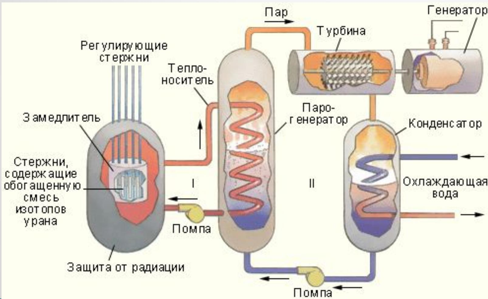
**В активной зоне ядерного реактора идет управляемая ядерная реакция с выделением большого количества энергии.**
