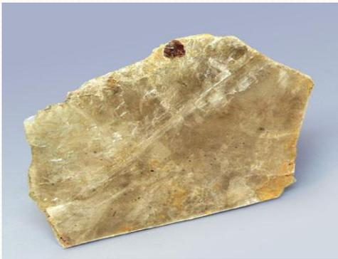
К выветриванию мусковит более стоек, чем биотит. Значительное количество слюды в составе горной породы значительно снижает механическую прочность, затрудняя полировку поверхности горной породы.
