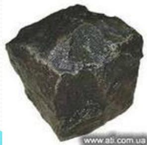
*Базальты* – излившиеся аналоги габбро, очень плотные породы черного цвета, трудно обрабатываются из-за большой твердости и хрупкости. Применяют в качестве бутового камня, являются исходным материалом для литых каменных изделий.
