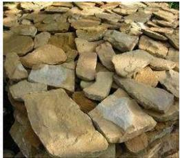
*Песчаники* – прочность их достаточно высокая, но они имеют большую среднюю плотность и высокий коэффициент теплопроводности. Применяются для фундаментов, облицовки зданий и опор мостов, как бутовый камень.
