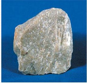
*Кварцит* – массивная горная порода, образовалась при метаморфизме кварцевых песчаников. Это сплошная зернисто-кристаллическая масса, в которой нельзя различить границу зерен кварца и природного цемента. Обладает очень высокой прочностью при сжатии – 1000 МПа; высокой атмосферо- и морозостойкостью; малым истиранием и высокой огнеупорностью. Применяется для облицовки гидротехнических сооружений, в качестве сырья для производства огнеупоров.
