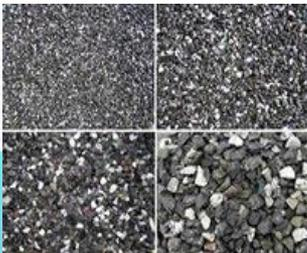
*Гравий, щебень* – образуются в результате неполного выветривания горных пород. Применяются как заполнитель для бетонов, в дорожном строительстве.
