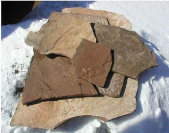
*Сланцы* образуются путем уплотнения глин. Порода не обладает полнокристаллической структурой; хорошо колется на тонкие плитки, может применяться в качестве кровельного материала.
