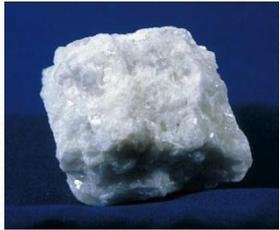
*Мрамор* – массивная горная порода, образовавшаяся из плотных известняков. Широко используется в облицовочных, художественных и скульптурных работах. Хорошо пилится и полируется.
