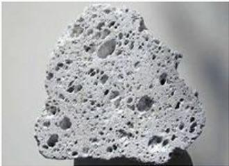
*Вулканические туфы* – образуются в результате последующей цементации рыхлых пород. Применяется в качестве легкого штучного стенового материала, как заполнитель для легких бетонов, в виде активной минеральной добавки.
