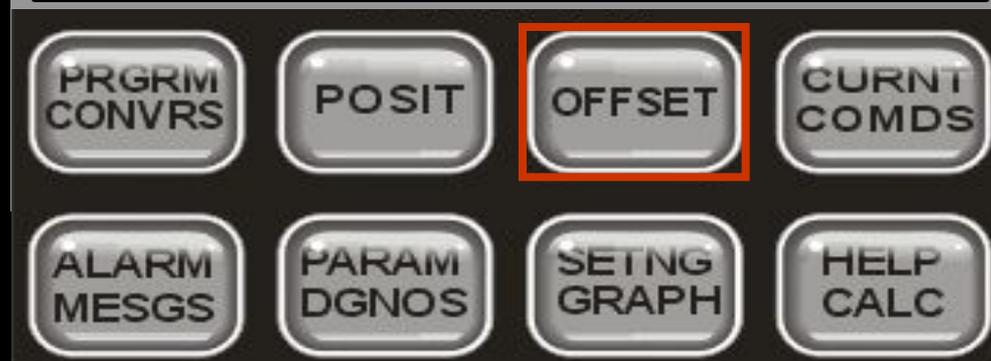
Размер инструмента может выбираться между Радиус и Диаметр установкой **Параметра 40**. Вы можете отображать до 200 различных инструментов, что задаётся **Параметром 90**.
