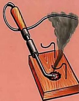
Отсутствие несгораемой подставки под электронагревательным прибором
