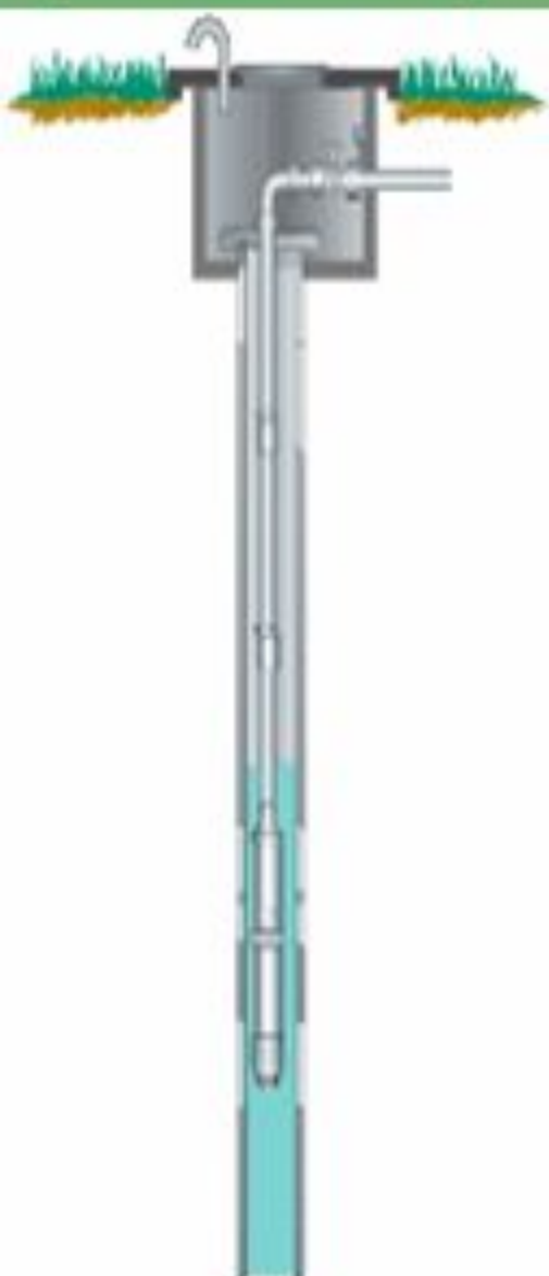
Водяная скважина и погружной насос
