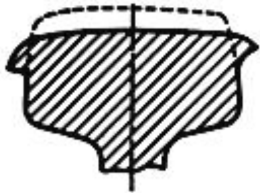
Износ рельса внутренней нити кривой из-за избытка возвышения
