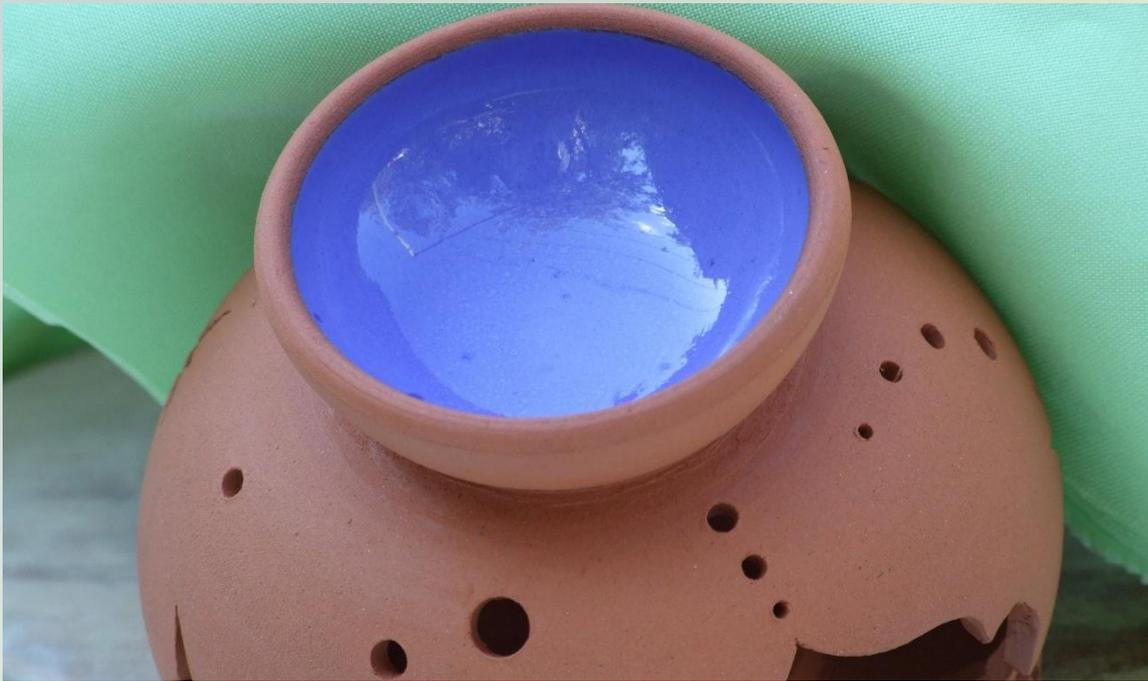
**Глазурь** – тонкий слой легкоплавкого стекла, который закрывает поры, сглаживает шероховатости, придает изделиям гладкий и блестящий вид.
