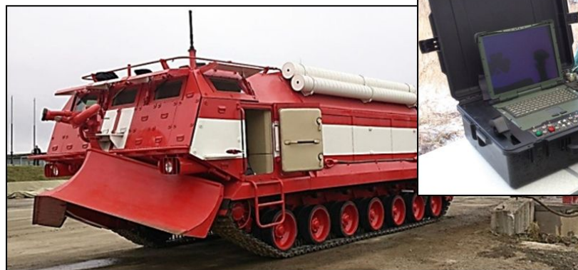
Дистанционное управление роботизированным комплексом пожаротушения
