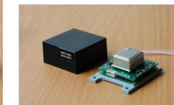
Микромеханические гироскопы для системы инерциальной ориентации (диапазон угловых скоростей \pm 150 град/с)
