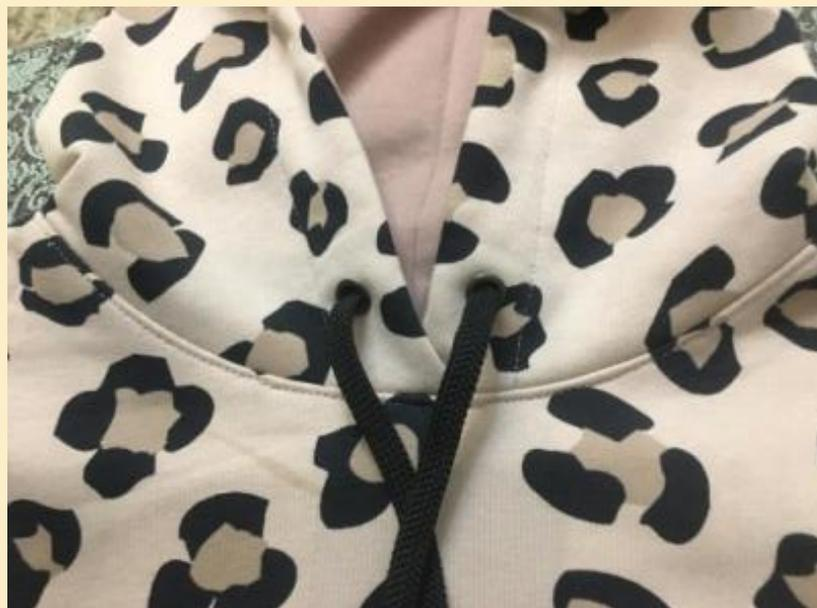
9. Капюшон отвернуть вверх, а припуски шва заутюжить на перед и спинку. Припуски шва приколоть. Шов втачивания капюшона отстрочить с лицевой стороны. К одному концу шнура приколоть английскую булавку. Шнур вдеть в кулиску капюшона через блочку, затем снять булавку.
