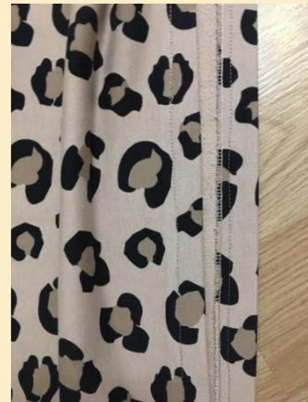
13. Припуск на подгибку низа худи обметать, заутюжить на изнаночную сторону и приколоть. Край отстрочить на расстоянии 1,7 см.
