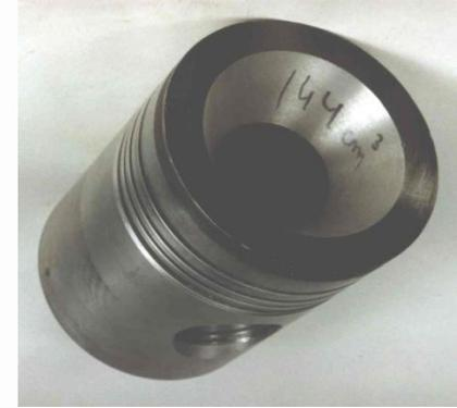
Модификация дизельного двигателя в двигатель с искровым зажиганием со следующими изменениями его конструкции:
