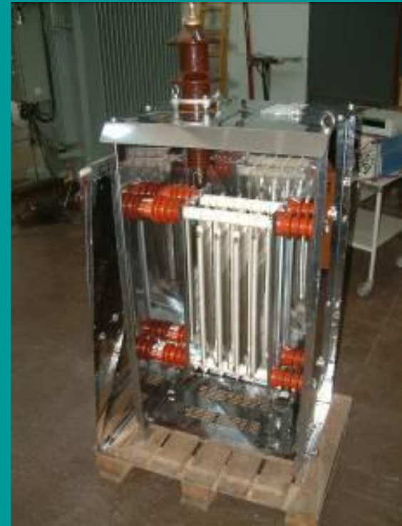
Резистор NER для заземления нейтрали сети 6 кВ, активное сопротивление 300 Ом, ток 11,5 А длительно
