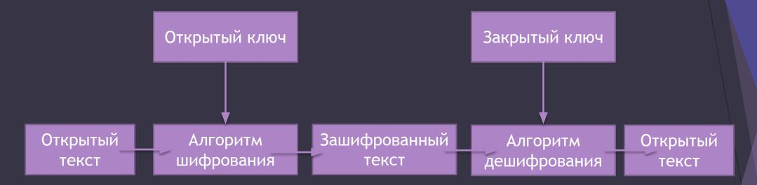
Шифрование с открытым ключом базируется на двух различных ключах — открытом и закрытом. Как показано на рисунке, открытый ключ используется для шифрования сообщений, а закрытый — для их дешифрации.
