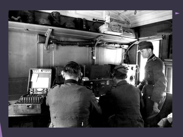
Эни́гма переносная шифровальная машина, использовавшаяся для шифрования и расшифрования секретных сообщений. Более точно, «Энигма» целое семейство электромеханических роторных машин, применявшихся с 20-х годов XX века.
