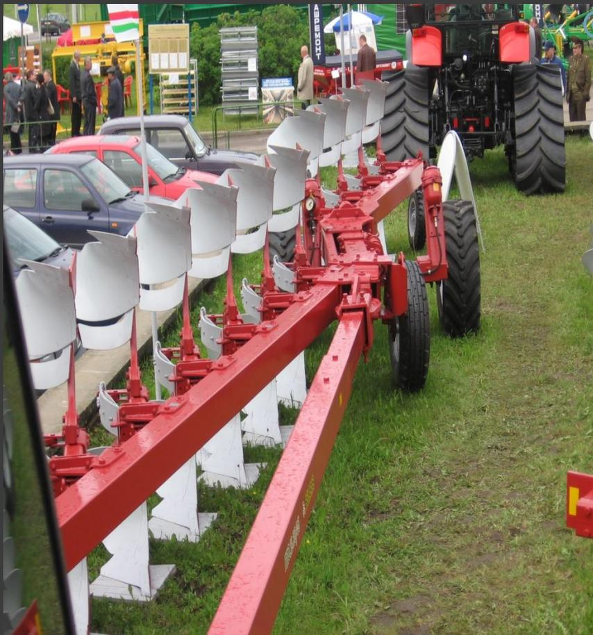
После луцения при появлении всходов сорняков проводят вспашку плугом с предплужником ПЛН-3-3,5, ПЛН-4-3,5, ПЛН-5-3,5 на глубину пахотного слоя.
