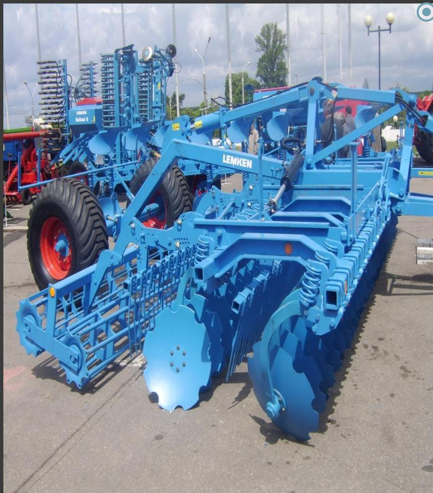
Лушение следует проводить луцильником ЛДГ-5, ЛДГ-10 мелко, на глубину 6...8см, в 2 следа или дисковыми боронами БДТ-3,0, БДТ-7,0.
