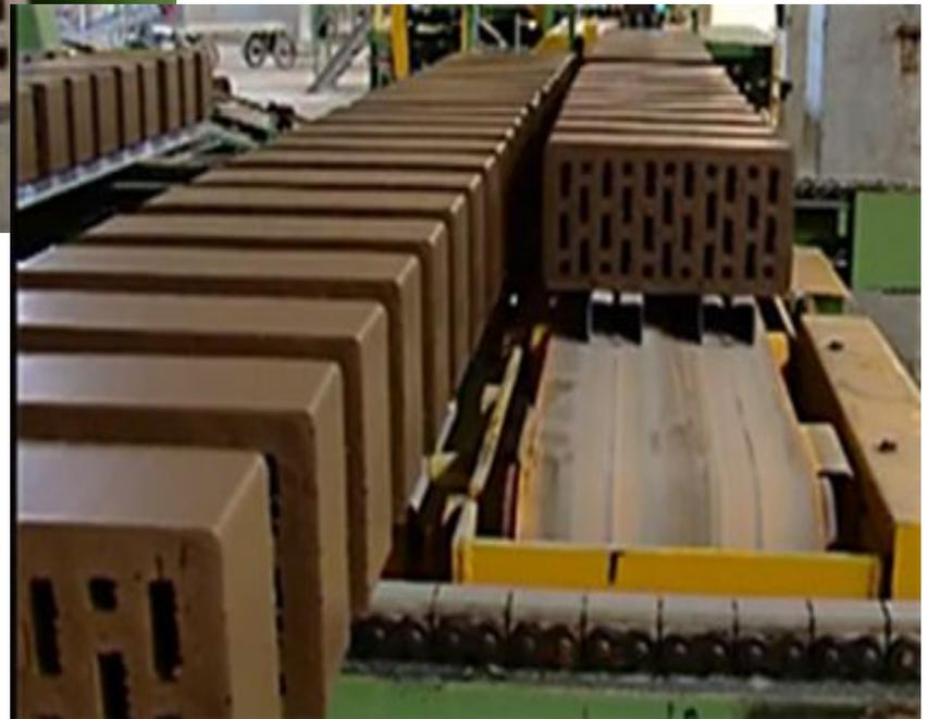
Еще один метод формовки заготовок – это *полусухое прессование*. Он позволяет значительно экономить потребление энергии и сократить время изготовления, но и качество при этом ухудшается. Метод не требует дополнительного досушивания заготовок.
