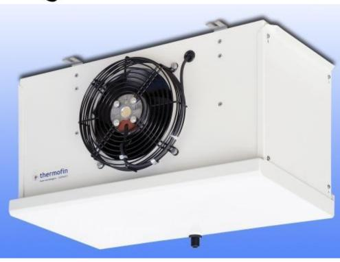
В них охлаждается не вода, а воздух, который движется между трубками испарителя. Внешне такой испаритель представляет собой теплообменник, состоящий из нескольких рядов медных трубок, по которым циркулирует хладагент. Диаметр патрубков в этом случае составляет 8 — 13 мм с расстоянием между ними — до 1.8 мм, по бокам имеется оребрение.
