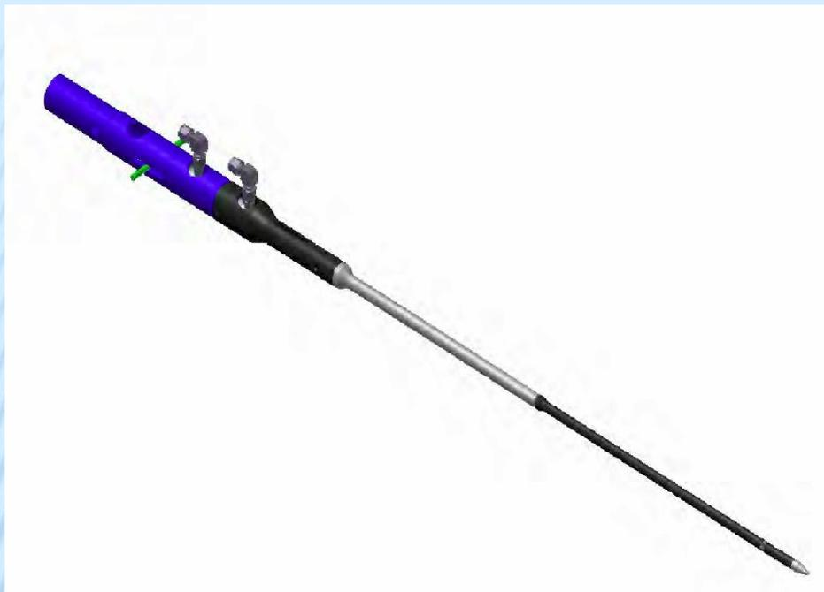
**Общий вид инструмента для демонтажа и установки стопорных труб**
