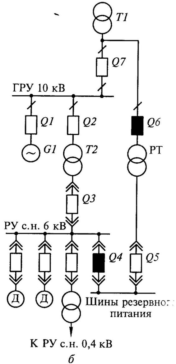
Показано присоединение рабочего и резервного трансформаторов с. н. к двойной системе шин ГРУ: рабочий трансформатор Т2 присоединен к первой системе шин К1, а резервный РТ — ко второй системе шин К2.
