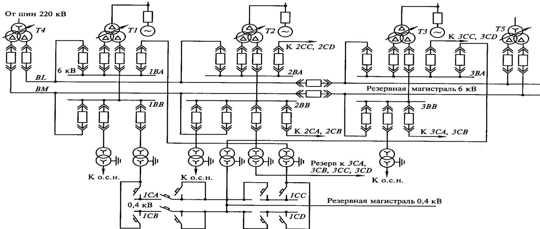
Приведена схема питания с.н. части блочной КЭС с тремя энергоблоками по 300 МВт. Трансформаторы с.н. Т1, Т2, Т3 питают секции 6 кВ соответственно первого энергоблока 1ВА, 1ВВ, второго 2ВА, 2ВВ и третьего 3ВА, 3ВВ. К этим секциям присоединяются электродвигатели 6 кВ турбинного и котельного отделений, общестанционная нагрузка (о. с. н.) и трансформаторы 6/0,4 кВ.
