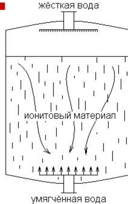
Диаметр частиц ионитового материала  $d \approx 1$  мм.
