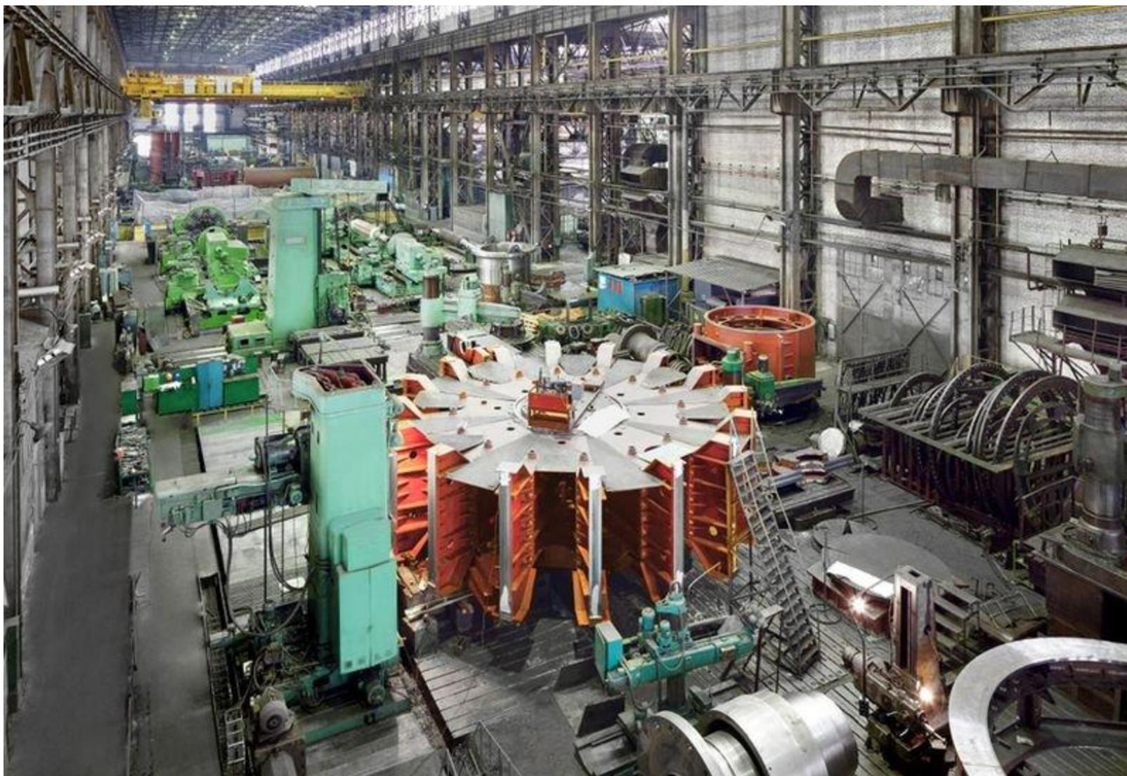
**Остов ротора гидрогенератора-двигателя в цехе завода
