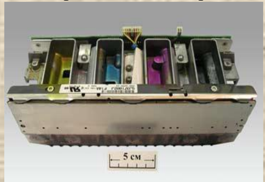
Печатающая головка твердочернильного принтера Xerox Phaser 8200
