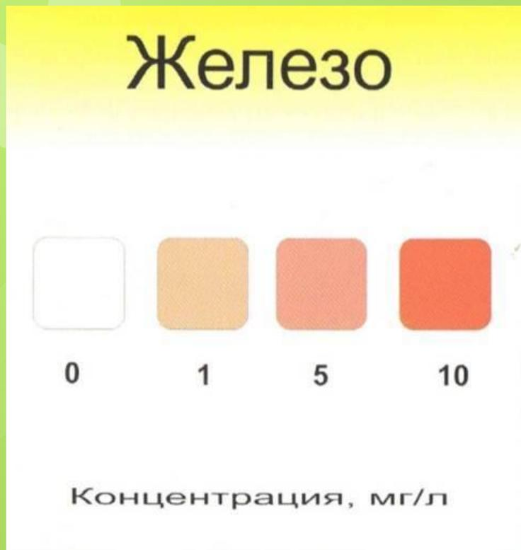
Метод определения железа основан на способности катиона железа (II) образовывать с ортофенантролином комплексное соединение. При наличии в воде железа (III) оно восстанавливается до железа (II) солянокислым гидроксиламином в нейтральной или слабнокислой среде по реакции:
