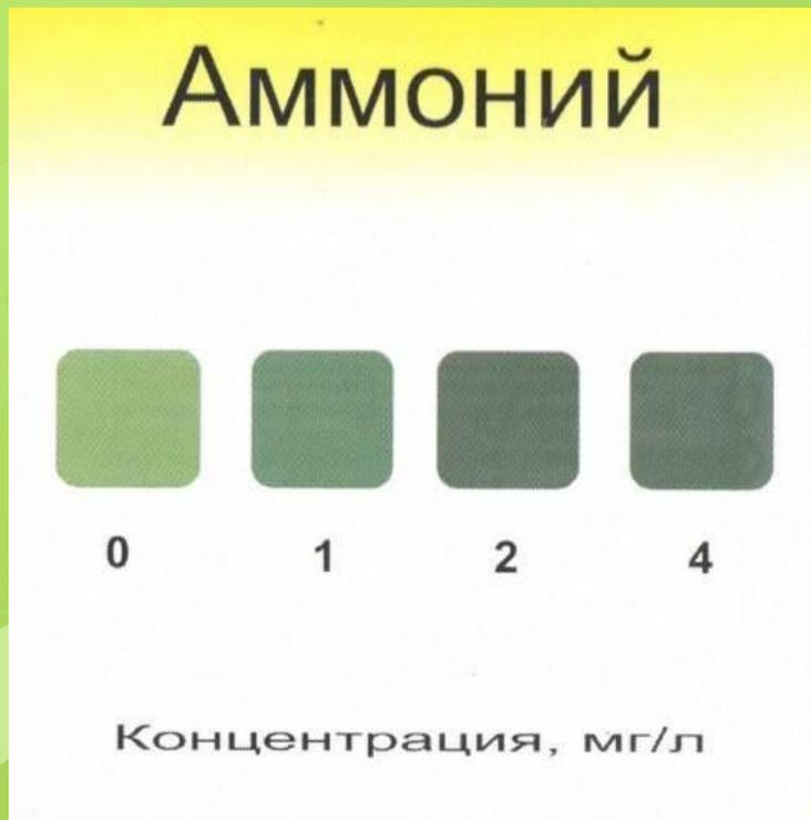
Метод определения массовой концентрации катиона аммония основан на его реакции с реактивом Неслера с образованием окрашенного в щёлочной среде в жёлтый цвет соединения:
