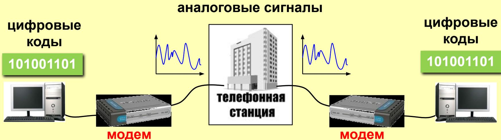
**Модем** – устройство для связи двух компьютеров с помощью телефонной линии.
