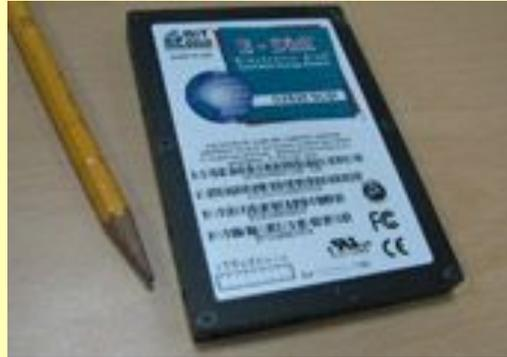
**SSD, solid-state drive** — компьютерное запоминающее устройство на основе микросхем памяти; кроме них, SSD содержит управляющий контроллер. Не содержит движущихся механических частей.
