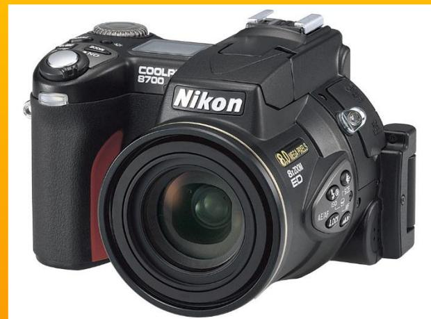
**Цифровая фотокамера** - фотоаппарат, в котором для записи оптического изображения вместо светочувствительного материала используется полупроводниковая фотоматрица и цифровое запоминающее устройство. Аналоговый сигнал с матрицы с помощью АЦП преобразуются в цифровые файлы и записывается на накопитель в фотоаппарате или другом внешнем устройстве.
