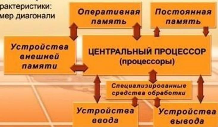
Компьютер обменивается информацией с внешним миром с помощью **периферийных устройств**. Только благодаря периферийным устройствам пользователь может взаимодействовать с компьютером, а также со всеми подключенными к нему устройствами.
