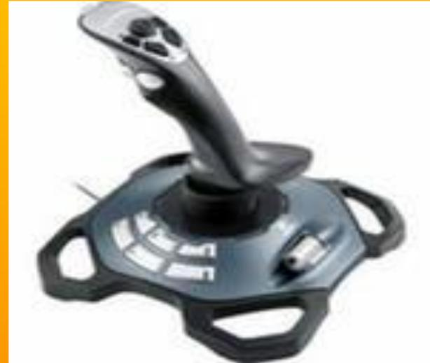
**Джойстик** представляет собой основание с подвижной рукояткой, которая может наклоняться в продольном и поперечном направлениях. Рукоятка и основание снабжаются кнопками. Внутри джойстика расположены датчики, преобразующие угол и направление наклона рукоятки в соответствующие сигналы, передаваемые операционной системе. В соответствии с этими сигналами осуществляется перемещение и управление графических объектов на экране.
