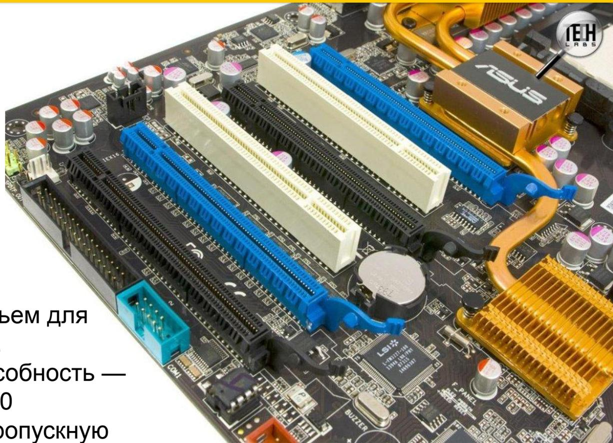
PCI Express или PCI-E — разъем для подключения видеоадаптера. Увеличенная пропускная способность — спецификация PCI Express 2.0 определяет максимальную пропускную способность одного соединения как 5 Гбит/с.
