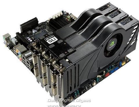
SLI - разработка компании «NVIDIA», позволяющая объединить усилия сразу нескольких устройств этой фирмы с целью повышения производительности работы системы. Scalable Link Interface (именно так расшифровывается SLI) достаточно требовательна к техническому обеспечению: материнская плата SLI с чипсетом NVIDIA (необходимо наличие двух и более портов PCI-Express), мощный и надежный блок питания, видеокарты GeForce с шиной PCI-Express и чипсетом одного семейства, соединитель (мост).
