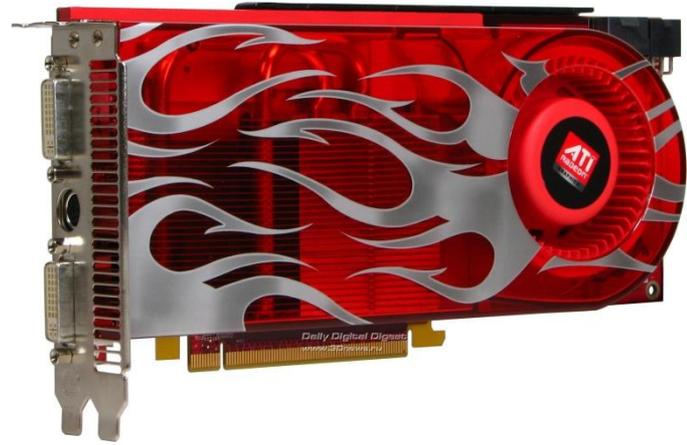
**Графический процессор** (англ. **graphicsprocessing unit, GPU**) — отдельное устройство персонального компьютера или игровой приставки, выполняющее **графический** рендеринг. ...
