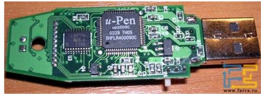
**USB-накопитель на флэш-памяти** - особый вид *энергонезависимой перезаписываемой полупроводниковой памяти.*
