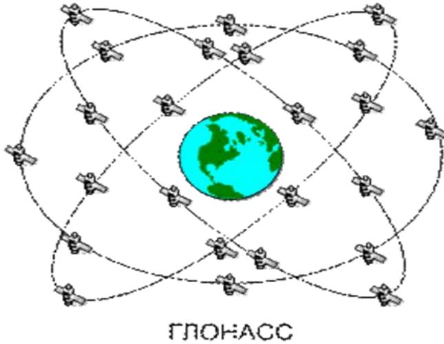
Космический сегмент системы ГЛОНАСС состоит из 24 навигационных космических аппаратов (НКА), находящихся на круговых орбитах высотой 19100 км, наклонением  $64,5^\circ$  и периодом обращения 11 ч 15 мин в трех орбитальных плоскостях (рис. 6.11). В каждой орбитальной плоскости размещаются по 8 спутников с равномерным сдвигом по широте  $45^\circ$ .
