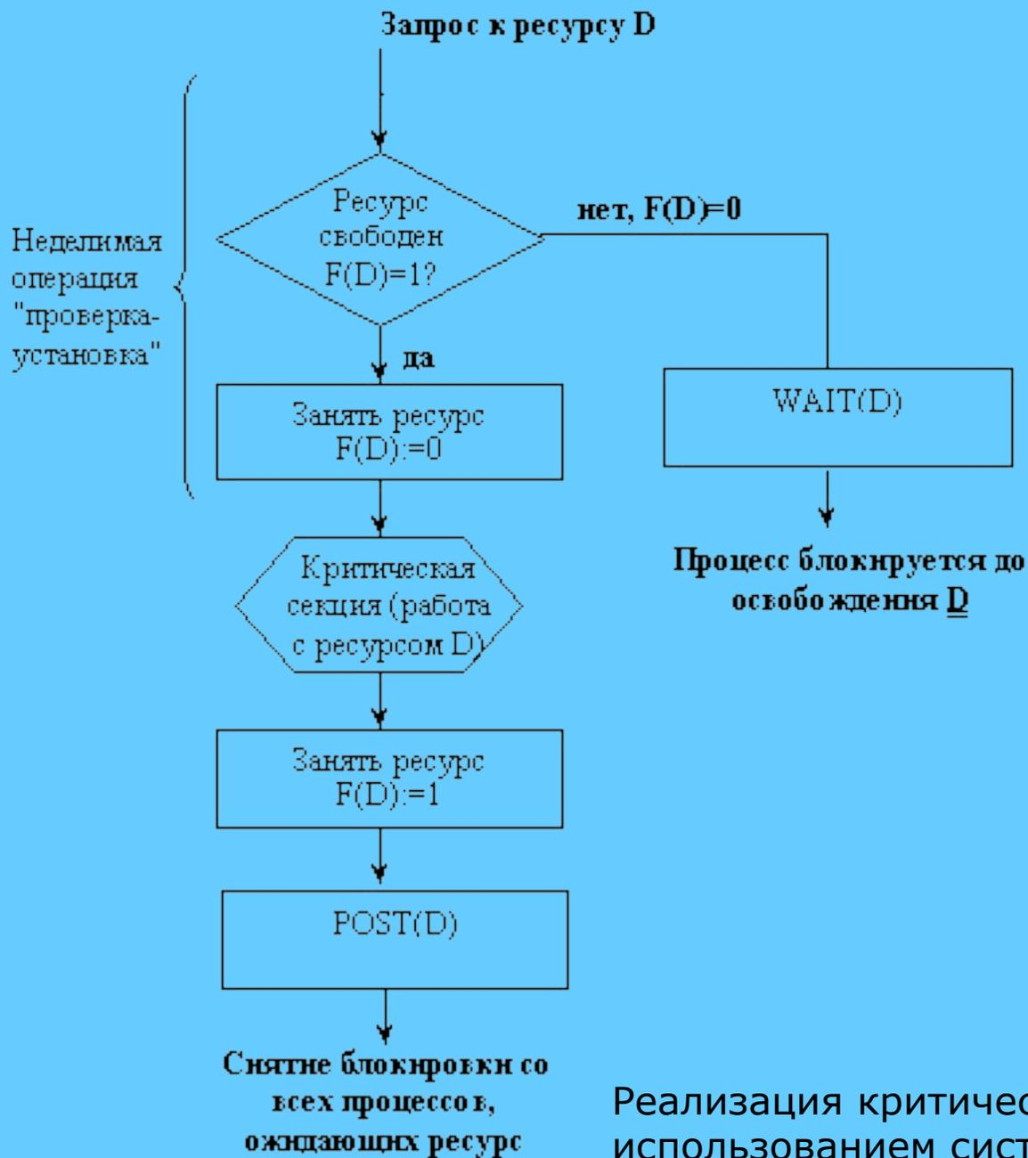
Реализация критической секции с использованием системных функций WAIT( $D$ ) и POST( $D$ )
