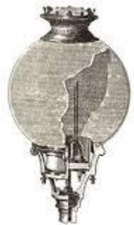
Фонарь для электрических свечей Яблочкова.
