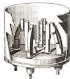
Держатель для электрических свечей Яблочкова.
