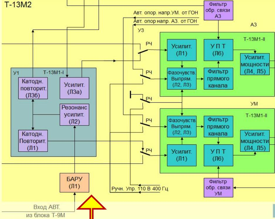
В КУА приемной системы (ДОГ) происходит выделение напряжения огибающей импульсов. С выхода приемной системы напряжение огибающей импульсов поступает в блок Т-13М2 на усилитель быстродействующей автоматической регулировки усиления (БАРУ).
