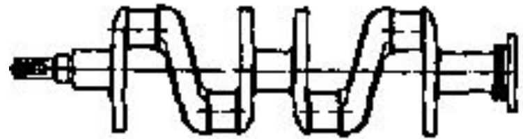
Коленчатый вал из высокопрочного чугуна
