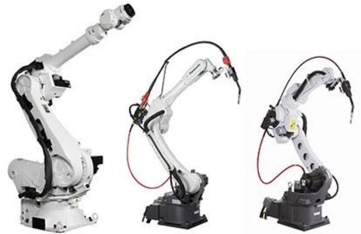
1. Промышленные роботы - автоматические машины, стационарные или передвижные, состоящие из исполнительного устройства в виде манипулятора, имеющие несколько степеней подвижности, и перепрограммируемого устройства программного управления для выполнения в производственном процессе двигательных и управляющих функций.
