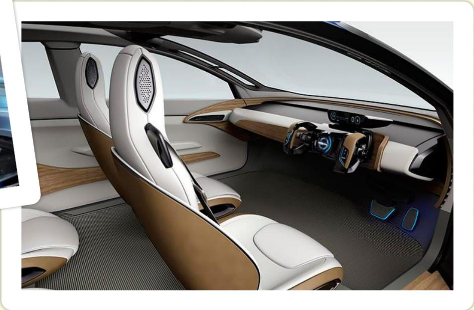
Уже сейчас Nissan готов предложить для серийного производства электрокар Nissan IDS с беспилотным управлением. При беспилотном режиме передние сиденья могут поворачиваться к задним, для удобного общения пассажиров. При выборе режима Piloted Drive, руль убирается и появляется дополнительная панель с информацией.
