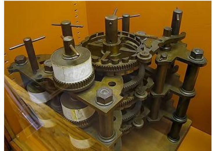
Фрагмент разностной машины Ч. Бэббиджа.
