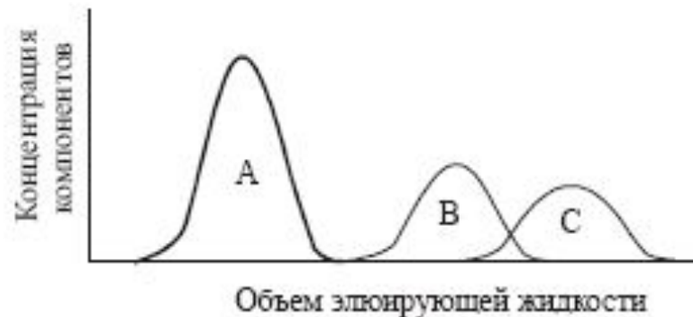
Рис. 4.12. Зависимость концентрации вытекающего раствора от объема элюирующей жидкости в элюентной хроматографии
