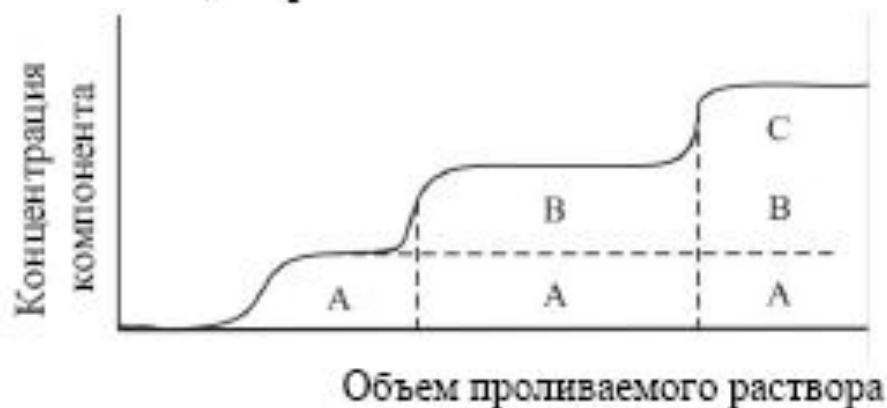
Рис. 4.11. Зависимость состава раствора на выходе из колонки от объема проливаемого раствора при фронтальном методе
