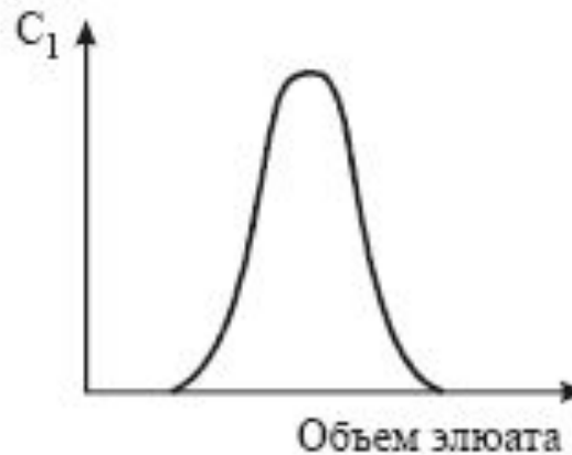
Рис. 4.17. Вид выходной кривой элюирования в динамических условиях (в колонне)
