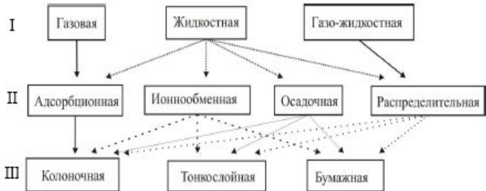
Рис.4.10. Классификация хроматографических методов: I – по агрегатному состоянию распределяющегося вещества; II – по механизму элементарного акта взаимодействия; III – по характеру осуществления процесса
