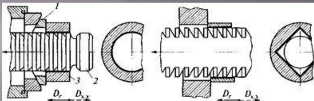
Технологическая схема протягивания
