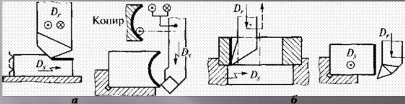
Технологические схемы строгания (а) и долбления (б) наружных поверхностей:
